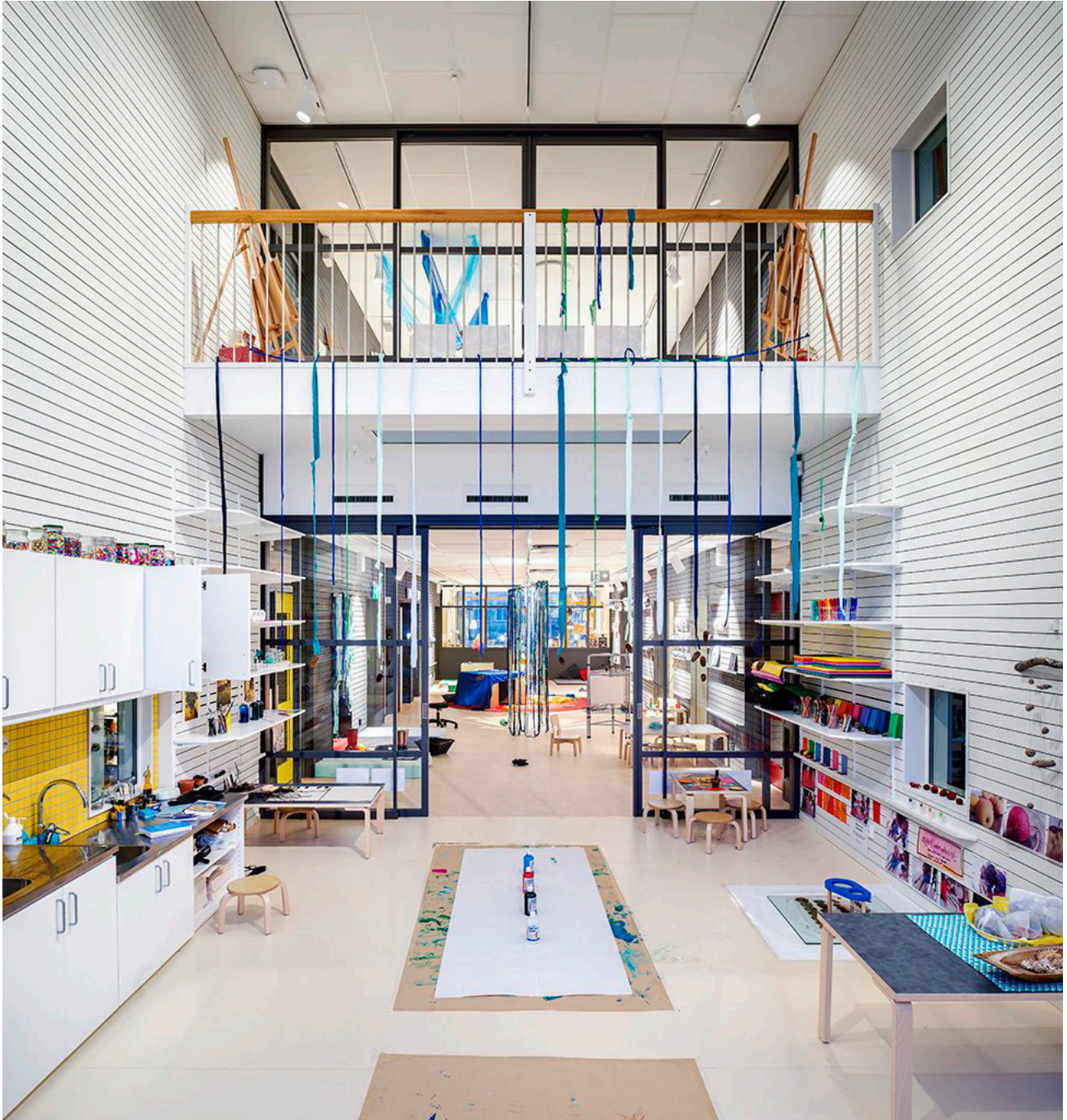
Exempel på flexibilitet för verkstad och ateljé där både stora och mindre rum kan skapas. Akustiken smälter in i rummets gestaltning och tillför rummet en ljus och varm känsla med träribbor och bakomliggande akustikabsorbenter. Hedlunda förskola, Umeå, SWECO Architects
